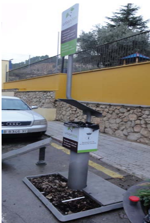
Figura 1. Imatge d'un dispositiu UrbanDog ubicat al municipi de la Palma de Cervelló. S'observa una de les dues reixes de la plataforma de recollida d'orins oberta, amb el material vegetal adsorbent.
